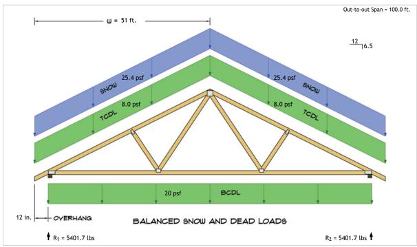
$$\begin{split} R_1 &= D + S = 2812.0 \text{ lbs} + 2589.7 \text{ lbs} \\ R_2 &= D + S = 2812.0 \text{ lbs} + 2589.7 \text{ lbs} \end{split}$$
