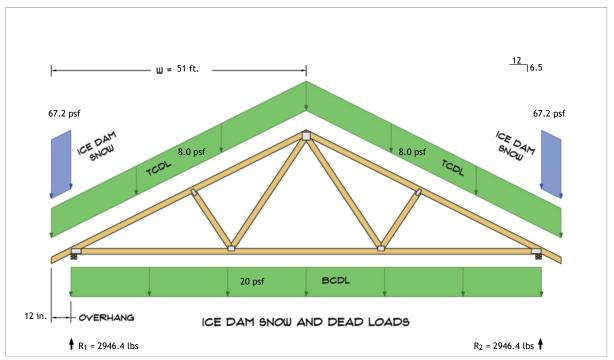
$$\begin{split} R_1 &= D + S = 2812.0 \text{ lbs} + 134.4 \text{ lbs} \\ R_2 &= D + S = 2812.0 \text{ lbs} + 134.4 \text{ lbs} \end{split}$$
